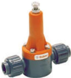
Le valvole di sfioro mantengono la pressione a monte costante in caso di incrementi di pressione superiori a quella di taratura. Possono essere montate sia in linea, in abbinamento a pompe; sia in derivazione per sfogare eventuali sovrappressioni.
