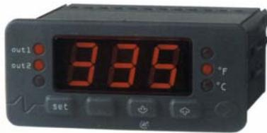
FK401 è un regolatore digitale ON-OFF a due uscite. Il controllore può essere configurato per eseguire uno dei tre tipi di regolazione: a due setpoint indipendenti, a un setpoint indipendente ed uno relativo, con regolazione a "zona neutra".
